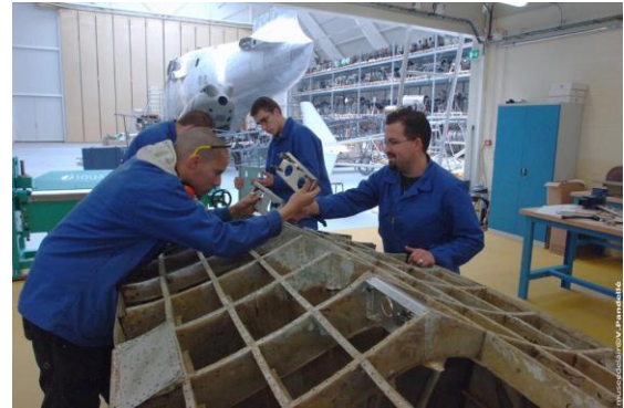
Restauration du flotteur du Bermuda
